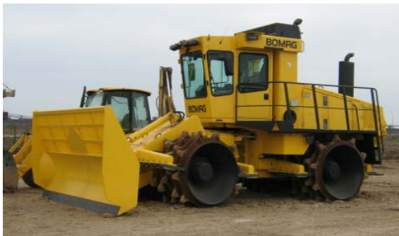
Figura 9-19: Echipament pentru exploatarea depozitului de deșeuri
