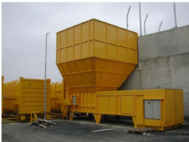
Figura 9-6: Exemplul unei unități de transfer al deșeurilor cu compactare
